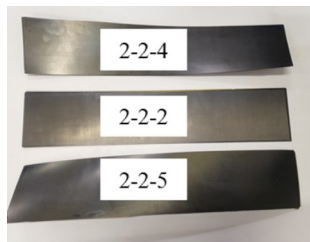
图2 非对称铺层平板的翘曲变形
