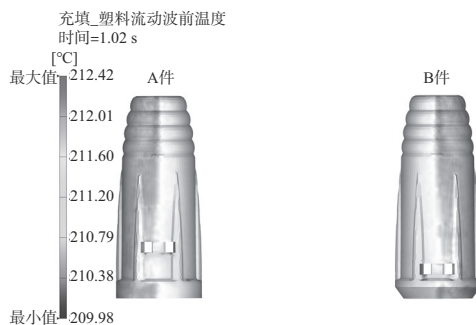
图6 塑件材料流动波前温度分析
