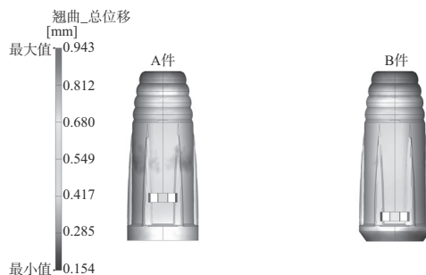
图10 塑件翘曲总位移分析
