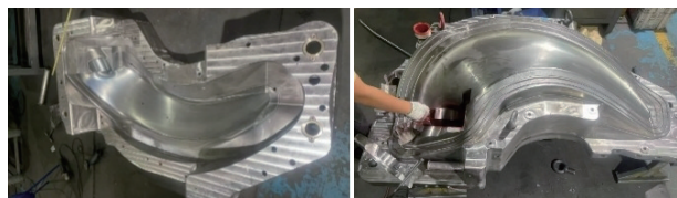
图9 复合材料异型夹层构件成型模具
