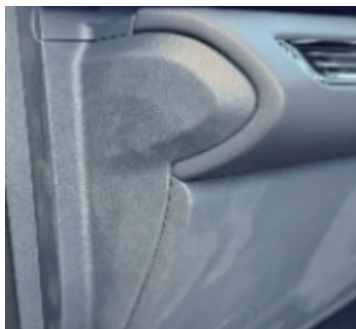
图1 零件发白的典型照片
