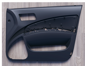
图7 质量合格的轿车车门内饰板实物照片
