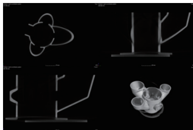
图14 三维编织接头CT检测
