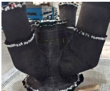
图11 三维编织接头预成型体
