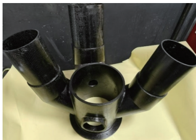
图13 实际成型的三维编织接头
