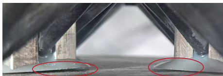
图13 面内剪切试验损伤照片
