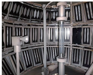
图1 湿热氙灯加速老化试验的样品排布
